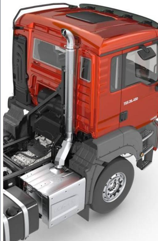
Bsp.: TGS mit hochgezogenem Abgasendrohr rechts hinter dem M-Fahrerhaus
